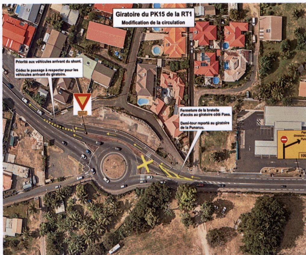
Schéma : Carrefour giratoire du PK15 de la RT1 Indiquant la modification de la circulation
